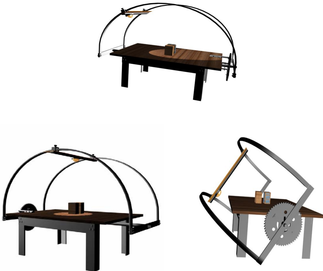
Рис. 2. Вид установки, моделирующей положение Солнца для различных вариантов.
